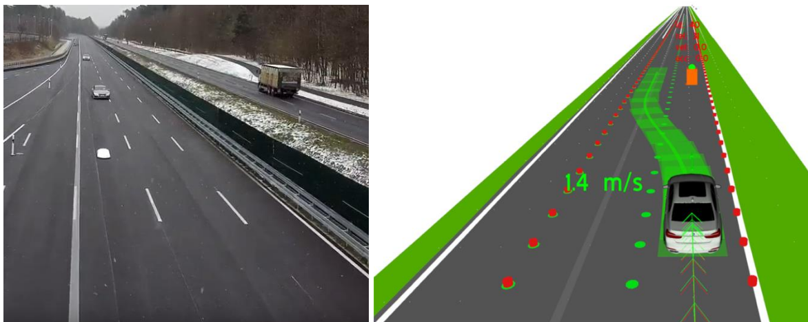
Abbildung 41: Das im Rahmen der Ko-HAF Abschlusspräsentation gezeigte Skibox-Szenario aus Vogelperspektive (Abbildung links). Hierbei wird das nachfolgende Fahrzeug durch das Vorderfahrzeug hinsichtlich der auf der Fahrbahn liegenden Skibox gewarnt. Die Gefahrenstelle wird im Rahmen der Trajektorienplanung der HAF-Funktion vorausschauend berücksichtigt (Abbildung rechts).
