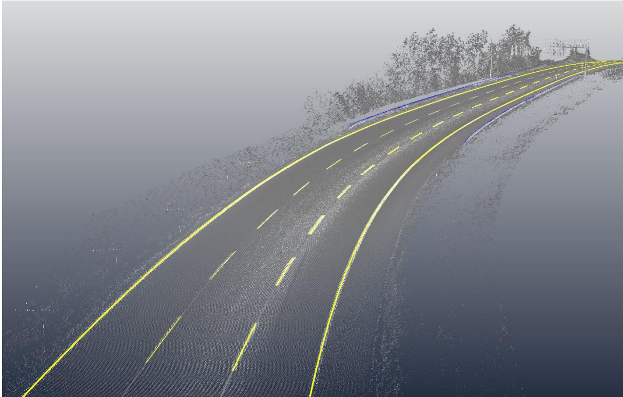
Abbildung 13: Extrahierte Markierungen als Grundlage für die Bildung der Spuren und Achsen.
