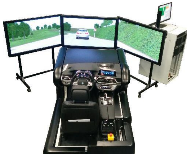
Abbildung 218: Mockup als Grundlage der virtuellen Erprobung.
