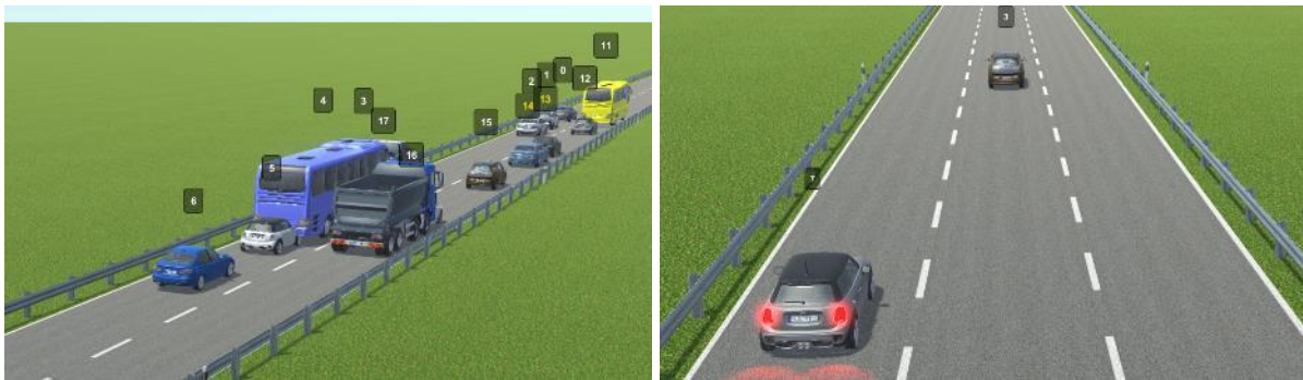
Abbildung 227: Exemplarische Darstellung des „Auffahren auf Stauende“- (links) und des „Objekt im Fahrstreifen“-Szenarios (rechts) für die Simulation in der Wirksamkeitsanalyse.
