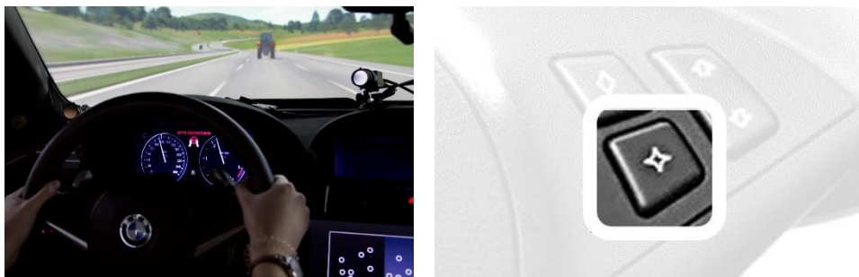
Abbildung 118: Fahrszene mit Eye-Tracking Kamera und Button zur De-/Aktivierung der Automation.
