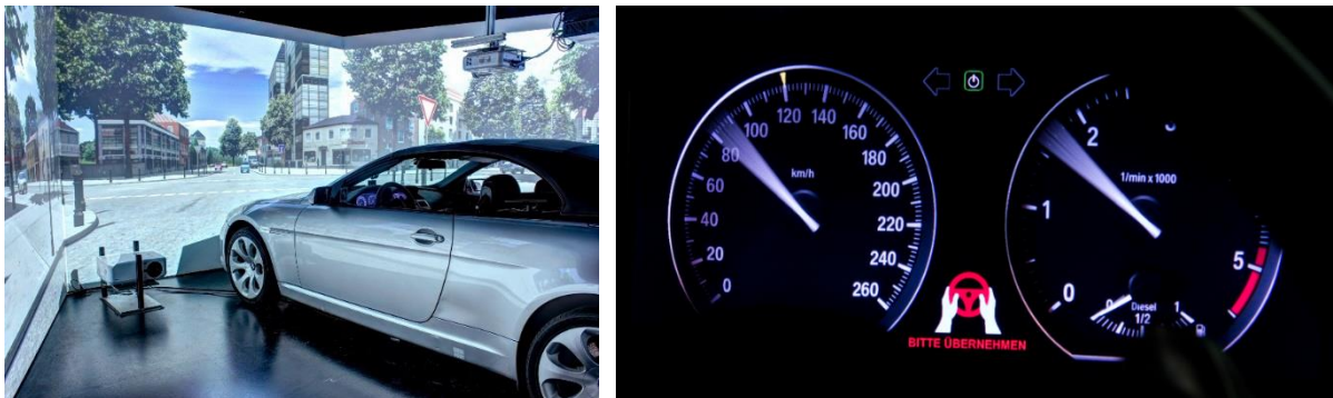
Abbildung 112: Statischer Fahrsimulators des Lehrstuhls für Ergonomie und Übernahmeaufforderung.
