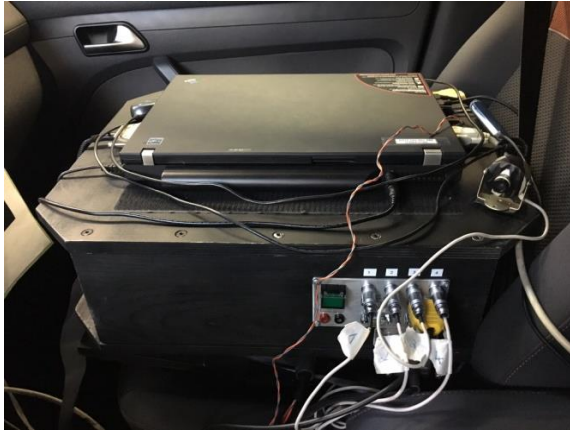
Abbildung 72: EEG-Messkoffer auf dem Beifahrersitz (Leihgabe der Daimler AG).
