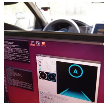
Software zur manuellen Ansteuerung der Anzeige Komponenten für „HMI-Wizard“ hinten rechts im Fahrzeug
