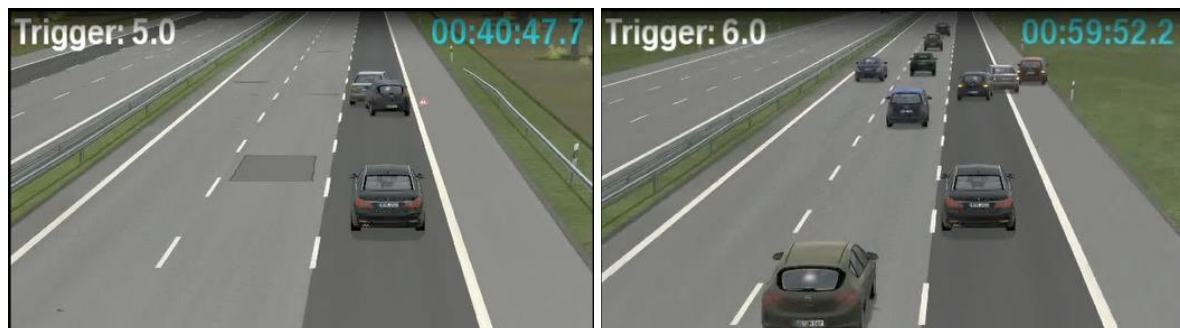
Abbildung 170: Übernahmesituation „Ausweichen“ und Übernahmesituation „Bremsen“.
