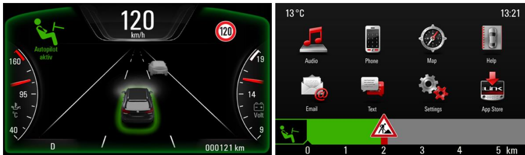
Abbildung 161: Links: Statusanzeigen und Umfelddarstellung im Kombiinstrument, Rechts: Vorschau über bevorstehende Übernahmesituationen im Mitteldisplay.
