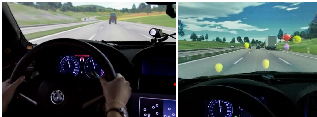
Abbildung 127: Fahrerszene mit Eye-Tracking Kamera und Semitransparentes Spiel im HUD.
