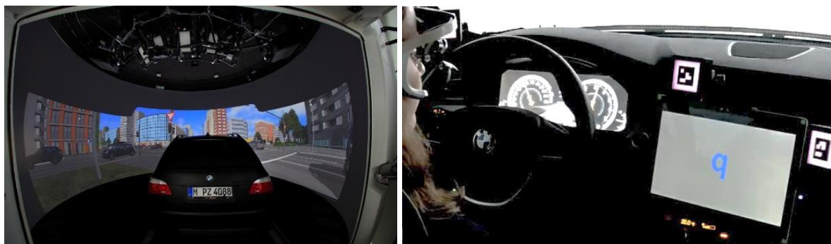
Abbildung 169: Dynamischer Simulator der BMW AG und Innenraumansicht mit „pqpd“-Aufgabe.
