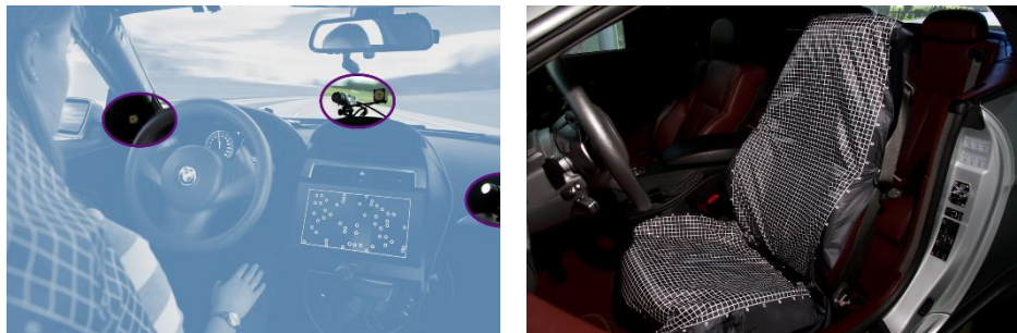
Abbildung 120: Position der Eye-Tracking Kameras im Fahrzeug und Sitzdruckmatten.
