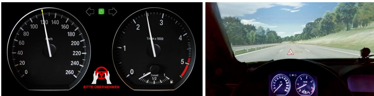
Abbildung 178: Generisches HMI der Versuche zum Fahrzustand und Anzeige des Head-Up Displays im statischen Fahrsimulators des Lehrstuhls in dem das optimierte Anzeigekonzept dargestellt wurde.
