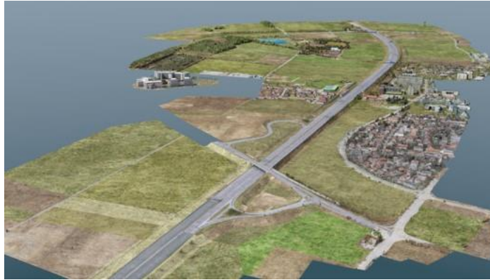
Abbildung 221: Ausschnitt der hochgenau nachmodellierten Umgebung für die Validierung umfelderfassender Rohdatenmodelle und Vergleich einer realen und virtuellen Fahrt.
