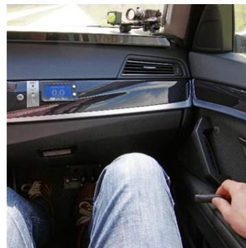
Bedienelemente für Längsregelung (Pedalerie im Fußraum) und Querregelung (Rotationshebel in Armablage)
