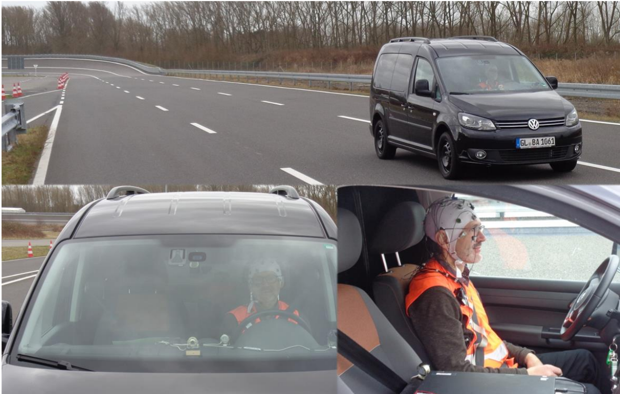
Abbildung 70: Oben: Wizard-of-Oz Fahrzeug auf monotoner Ovalbahn des Versuchsgeländes. Links: Im Bereich des Innenspiegels: Kamera zur Messung der Spurposition während der automatisierten Fahrt. Auf dem Dashboard: Kameras für Videoaufzeichnungen des Fahrers. Rechts: Proband im Fahrzeug während kontinuierlicher Überwachungstätigkeit mit EEG-Ableitung, in seiner Hand befindet sich ein Taster.
