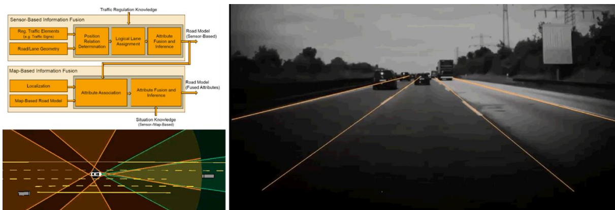
Abbildung 194: Continental Teves: Modell für die Umfelderkennung aus Sensoren und Karte (links oben); fusioniertes Umfeldmodell aus statischen und dynamischen Elementen (links unten); erkannte Linien und deren Repräsentation (rechts).
