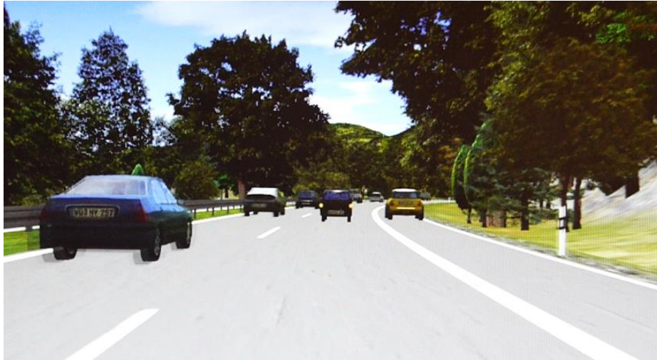
Abbildung 132: Übernahmesituation: Unfallwagen auf Ego-Spur (TTC = 6 vs. 8s).
