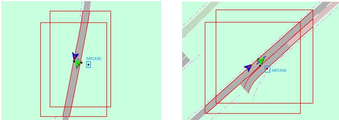
Abbildung 46: Fusionierte Fahrzeugposition unter Einbindung der Surroundview Kameras (grün), GPS-Position (blau), Prädiktion der lateralen Position rein über Monokamera MFC430 (markiert).
