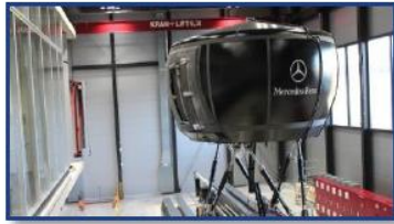
Fahrsimulator „Moving Base“
