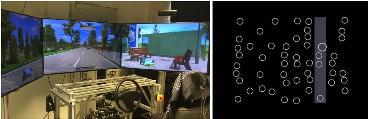
Abbildung 123: Verwendete Sitzkiste des Lehrstuhls für Ergonomie und Darstellung des verwendeten Surrogate Reference Tasks (SuRT).
