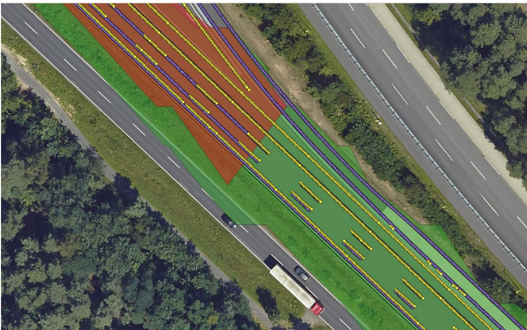
Abbildung 28: Der rote Bereich repräsentiert den korrekt gefundenen Änderungsbereich bei geänderten Spurmarkierungen.
