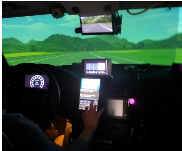
Abbildung 130: Simulatorsetting mit HMI-Anzeigeelementen und Fahrfremder Tätigkeit (Tablet in Halterung).
