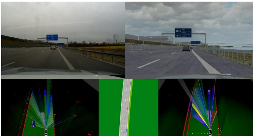
Abbildung 222: Visualisierung einer realen und virtuell nachgestellten Fahrt mit entsprechenden Sensor- und Fusionsergebnissen.
