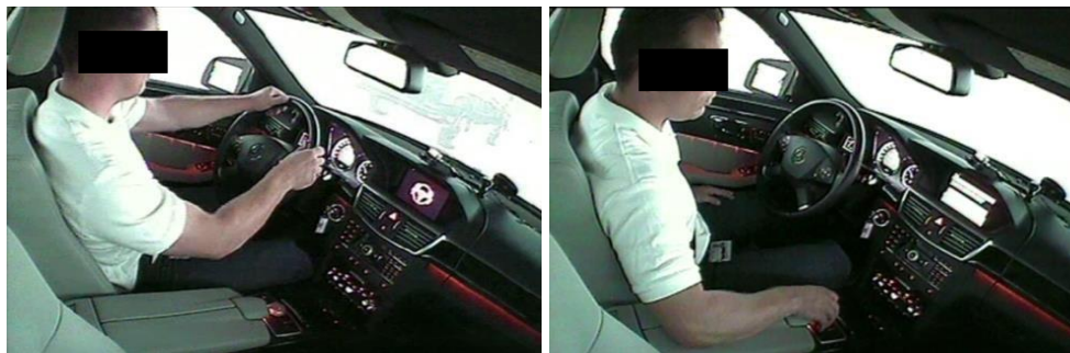
Abbildung 134: Links: Übernahmeaufforderung im Kombi-Instrument. Rechts: Fahrer während der Ausübung einer fahrfremden Tätigkeit.
