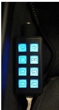
Bedienelemente für Sekundärfunktionen (links) und Zu-/Abschaltung der steer-by-wire-Lenkung (rechts)
