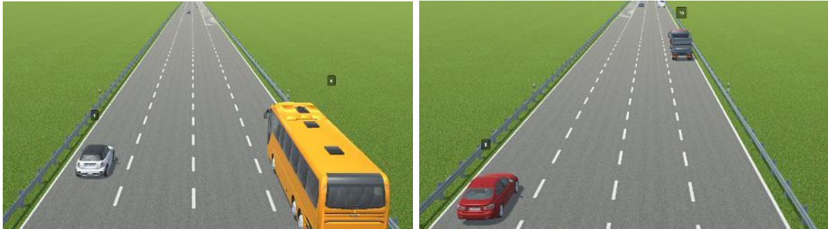
Abbildung 226: Exemplarische Darstellung des Auffahrt- (links) und Fahrstreifenende-Szenarios (rechts) für die Simulation in der Wirksamkeitsanalyse.
