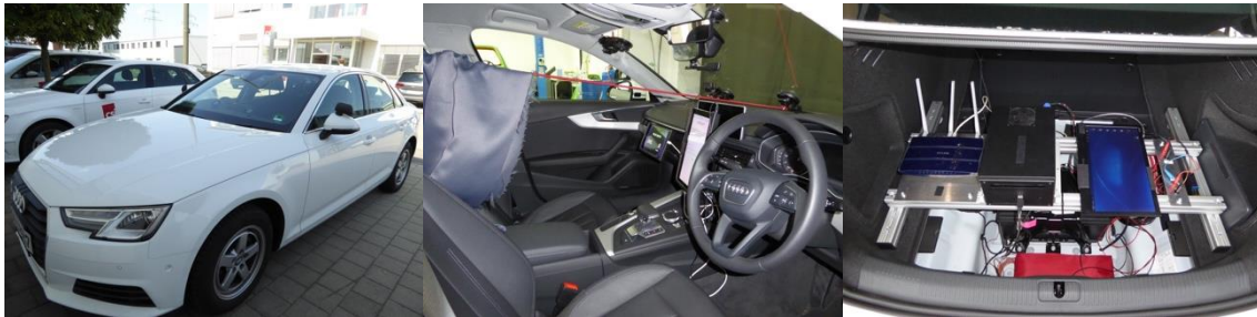
Abbildung 66: Versuchsfahrzeug: modifizierter A4 -Rechtslenker.
