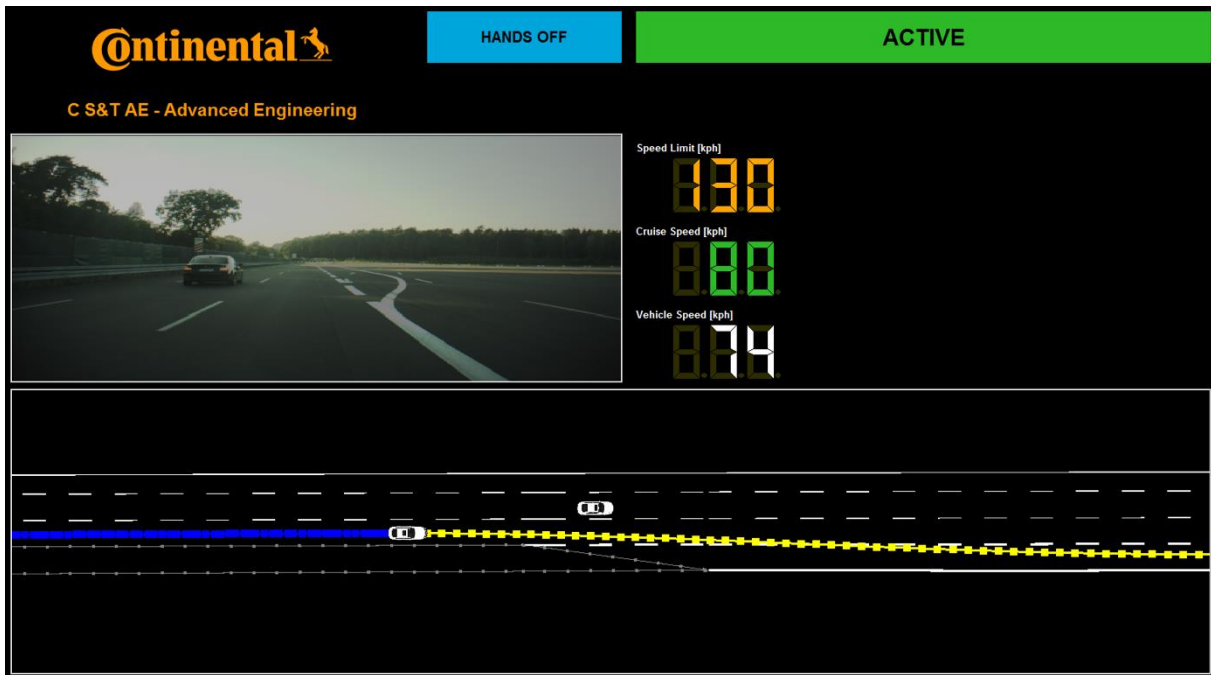
Abbildung 199: Aufnahme am Anfang des Ausfahrstreifens von der Langen Geraden in Dudenhofen; das Hasenfahrzeug auf der linken Spur wird von der Sensorik und auf der Umfeldarstellung gezeigt.
