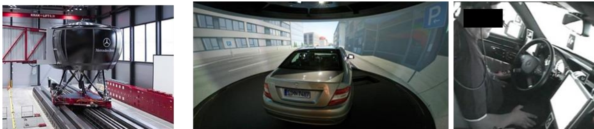
Abbildung 138: Links: Mercedes-Benz Fahrsimulator. Mitte: Ansicht innerhalb der Simulatorzelle. Rechts: Ansicht des Fahrzeuginnenraums mit Display für die fahrfremde Tätigkeit.
