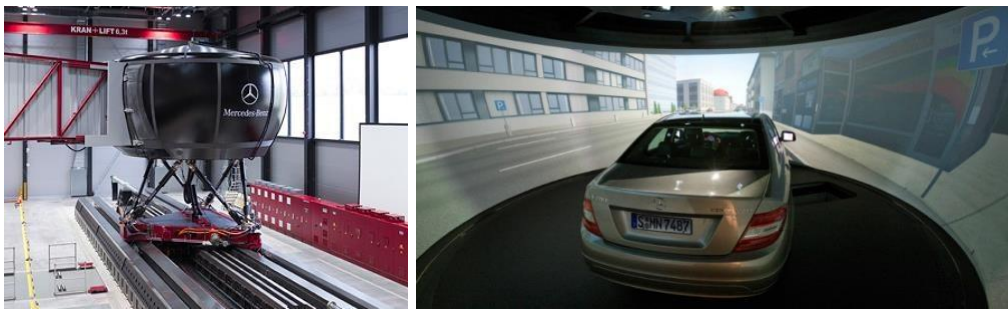
Abbildung 133: Links: Mercedes-Benz Fahrsimulator. Rechts: Ansicht innerhalb der Simulatorzelle.
